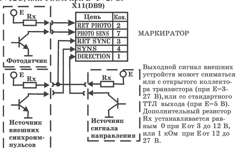
Рис. 16. Подключение внешних сигналов на разъём ДАТЧИК 1
